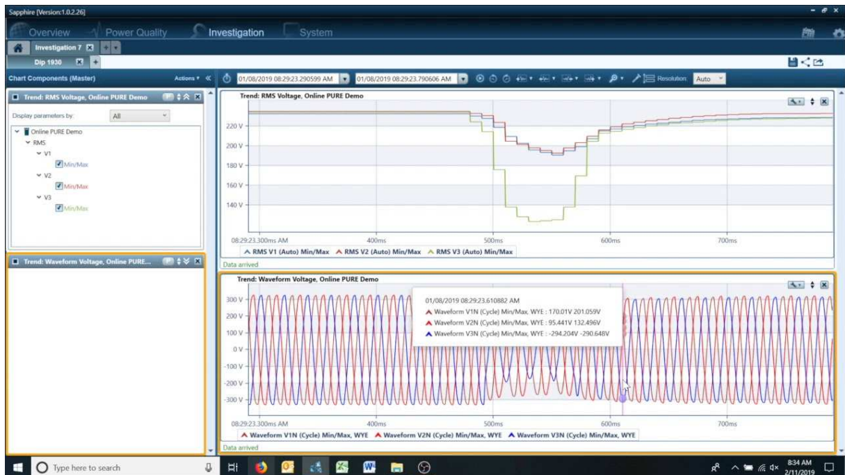
Gráfico 6. PQS Saphire analizador de registros.
