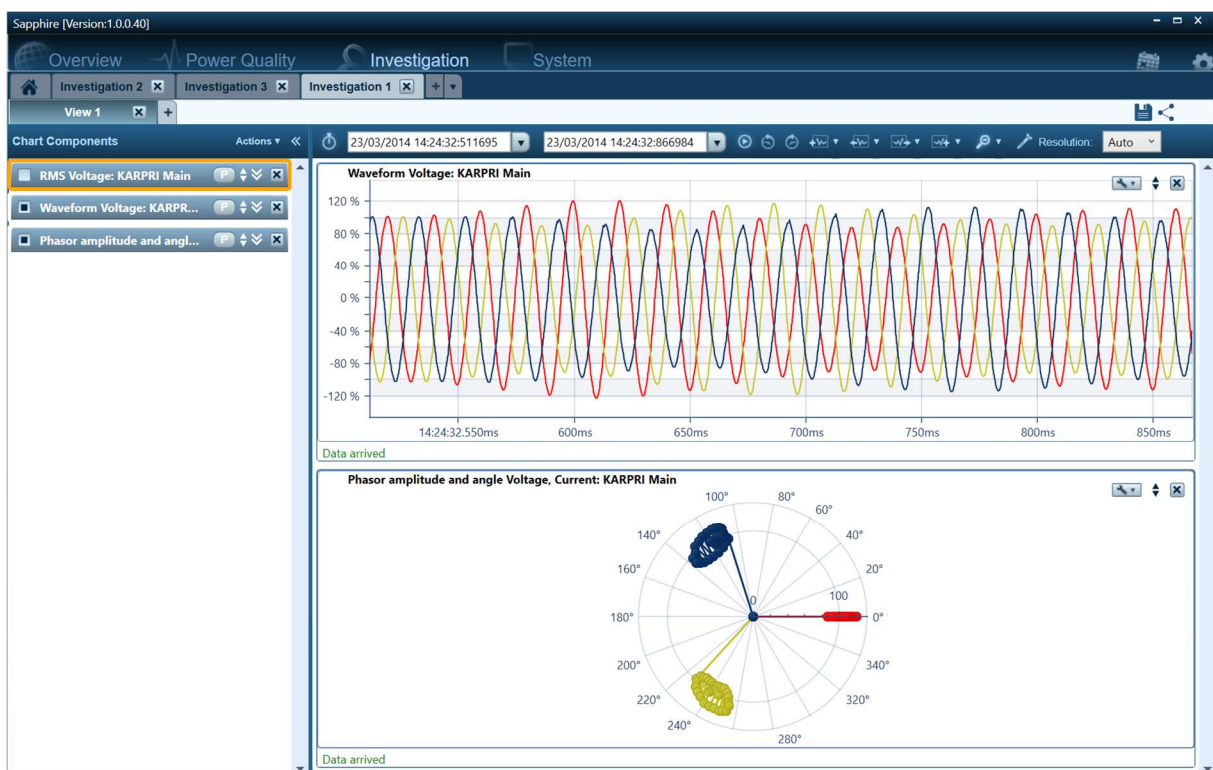
Gráfico 5. PQS Sapphire analizador de registros.
