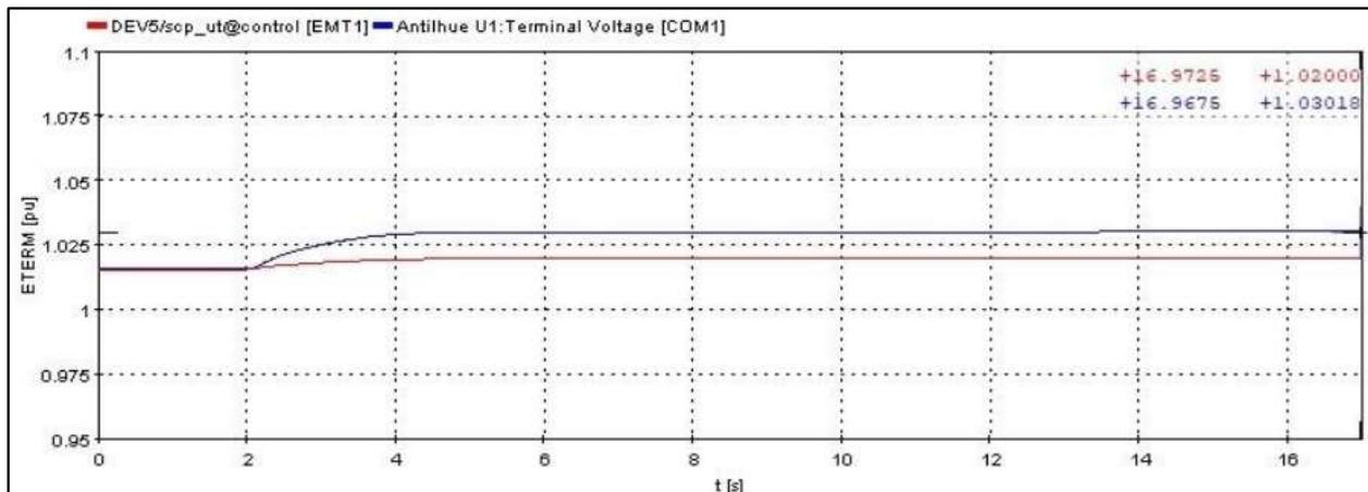
Esto también ocurre para las simulaciones del AVR en vacío y para la validación de los modelos de OEL y PSS. En consecuencia, se deben efectuar las modificaciones necesarias para que reduzca el error de estado estacionario y logre el efecto esperado al aplicar un escalón de tensión.
