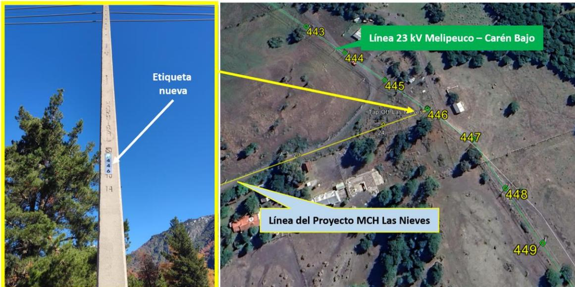
**Figura 2: Identificación actualizada de las estructuras de la línea 23 kV Melipeuco – Carén Bajo, donde el punto de conexión del Proyecto MCH Las Nieves corresponde en realidad a la “Estructura N°446”.**
