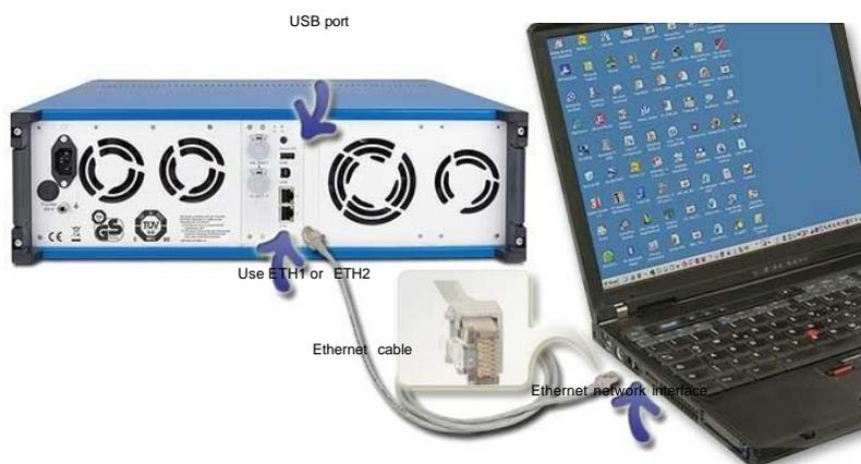
Se deberá Instalar el notebook y cable de comunicación Ethernet con maleta de pruebas Ómicron y Switch con la protección 87B.
