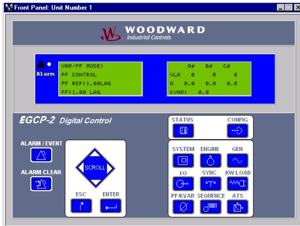
Figura 4-9. Estado de PF/KVAR
