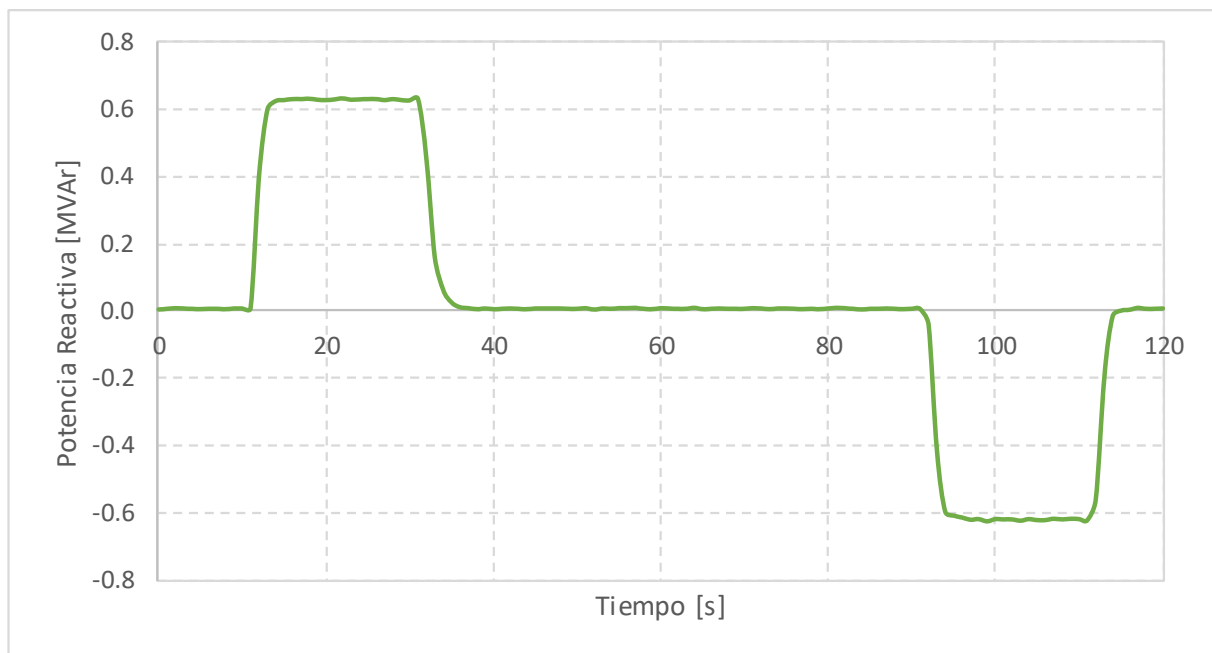
Gráfico 48. Control de potencia reactiva a nivel inversor. Baja Carga. Variables temporales.
